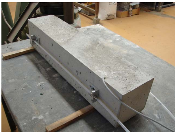
Obr. 3: Betonový trámec s osazenými optovláknovými extenzometry
