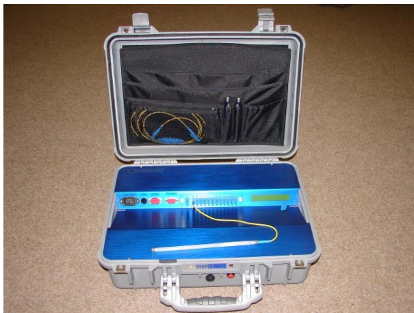
Obr. 1: Měřicí zařízení s referenčním optovláknovým snímačem
