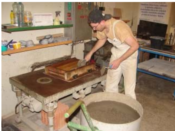
Obr. 12: Výroba doprovodných těles
